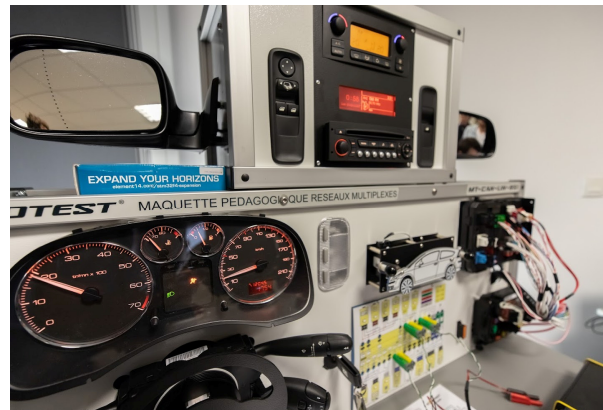
Maquette pédagogique réseaux multiplexés - UBS
